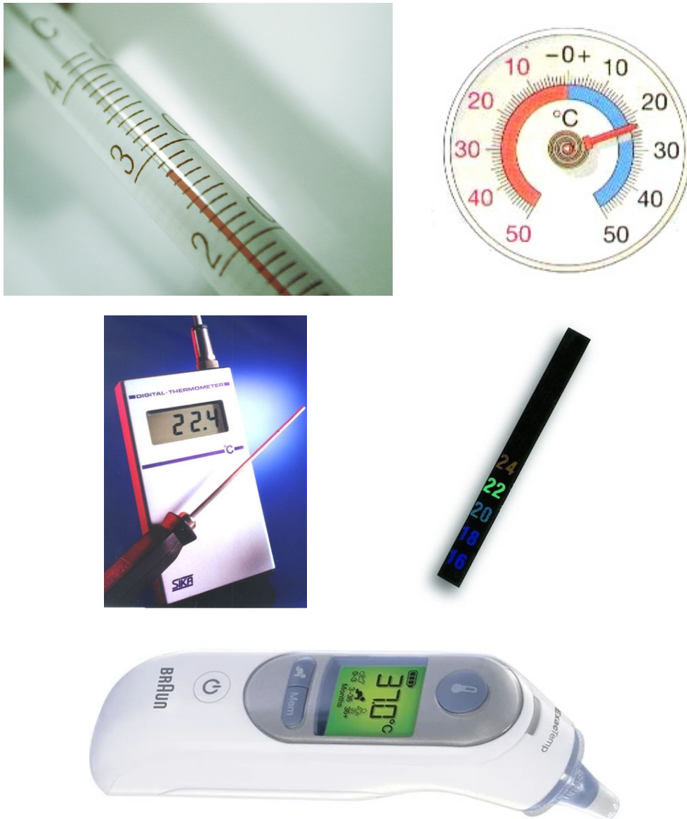
Abbildung A.1: Verschiedene Thermometertypen: Oben links die Skala eines Flüssigkeitsthermometers, oben rechts ein Bimetallthermometer zur Messung der Aussentemperatur, in der Mitte links ein Widerstandstempersensor, rechts davon ein Flüssigkristallthermometer und schliesslich unten ein Infrarot-Thermometer zur Messung der menschlichen Körpertemperatur (im Ohr).
