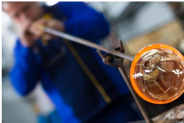
Abbildung 2.6: Das Glas wird bei einer Temperatur von ca. 1300 °C geblasen und in die gewünschte Form gebracht.
