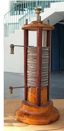
Abbildung 2.2: Charles Augustin de Coulomb (1736 – 1806), Alessandro Volta (1745 – 1827). Nebenbei: Auf Voltas Bild sieht man im Hintergrund rechts ein seltsam anmutendes, stapelartiges Objekt. Dies ist eine Volta'sche Säule , also eben eine dieser ersten brauchbaren Batterien! Rechts wird dieses historische Objekt noch etwas größer und als Fotografie gezeigt.
