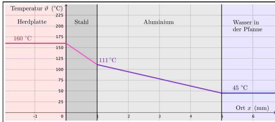
Die Kontaktfläche zwischen dem Stahl und dem Aluminium liegt folglich auf etwa  $111^\circ\text{C}$  und die Temperaturgradienten in den beiden Materialien sind gegeben durch:
