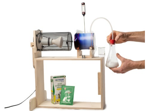
Experiment: Absorption von Wärmestrahlung I
