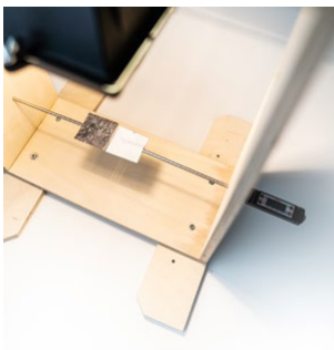
Abbildung 24 – Modellexperiment zur Albedo aus dem Klimakoffer. Bei gleicher Beleuchtung erwärmt sich der dunkle Körper stärker.
