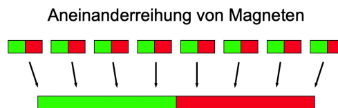
Abbildung 6.4: Bei der Aneinanderreihung mehrerer kleiner Magnete verschwinden deren Pole. Der neu entstehende Magnet hat nur noch Pole an seinen Enden.
