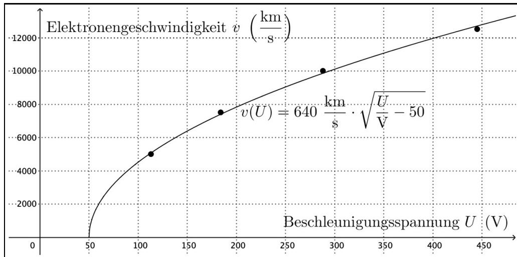
Dass die Kurve nicht durch den Nullpunkt verläuft, hat damit zu tun, dass der Mechanismus der Strahlbündelung in unserem Fadenstrahlrohr der Beschleunigung leicht entgegenarbeitet und dass ein Teil der Beschleunigungsspannung doch immer noch dafür benötigt wird die Elektronen aus dem Material zu holen. Deshalb können offenbar erst ab einem Minimalwert von 50 V Spannung Elektronen beschleunigt werden.
