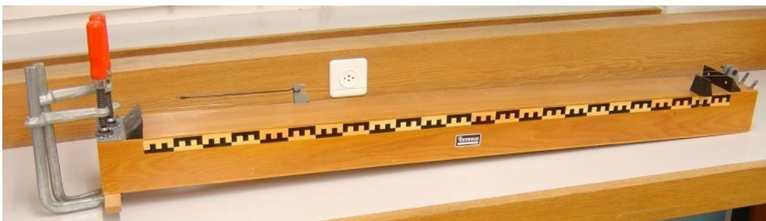
Abbildung 32: Das Monochord aus dem Unterricht.
