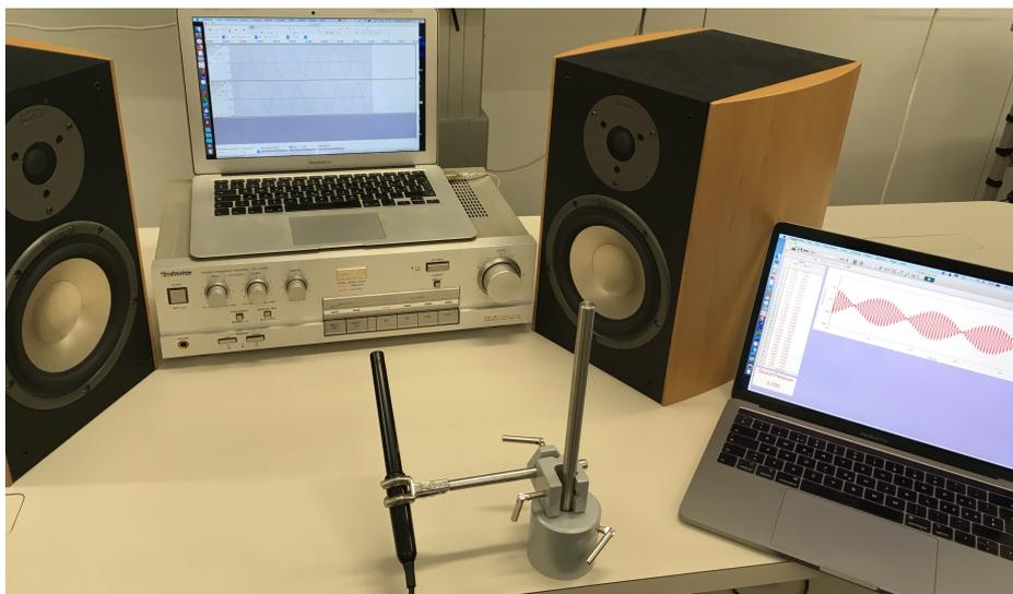
Abbildung 46: Das Versuchssetting zur Schwebungsmessung: Zwei Lautsprecher erzeugen je einen Sinuston. Das Mikrofon registriert die Überlagerung beider Wellen.
