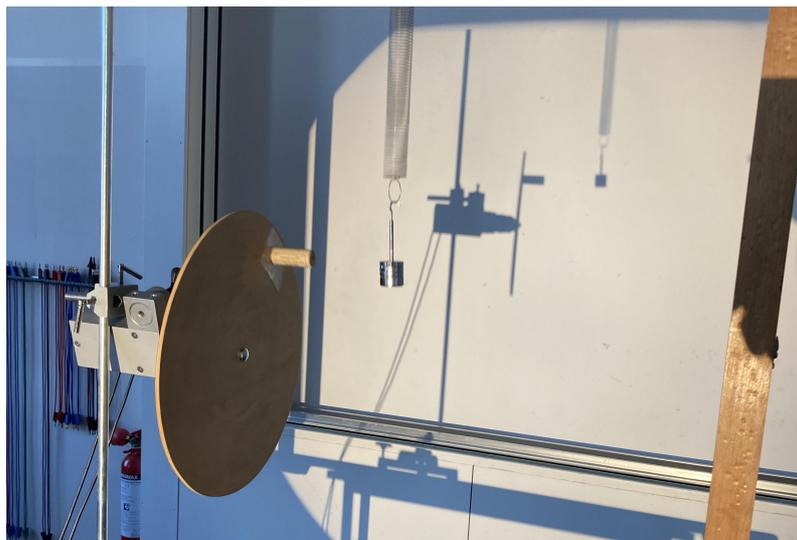
Abbildung 30: Drehende Scheibe und Federpendel nebeneinander: Der Schatten des Korkzapfens auf dem Scheibenrand und derjenige des Federpendels bewegen sich perfekt miteinander auf und ab.
