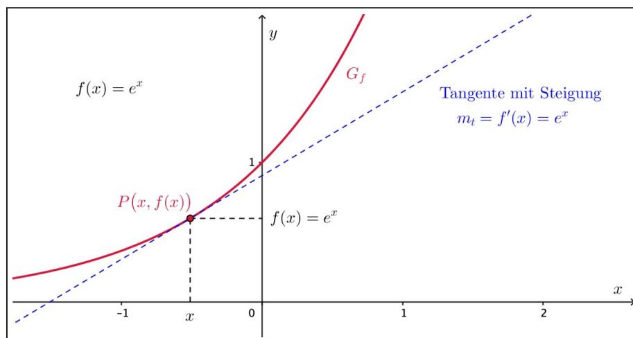
Abbildung 2: Die spezielle Eigenschaft der Exponentialfunktion  $e^x$ : In jedem Punkt  $P(x, e^x)$  auf dem Funktionsgraphen besitzt die zugehörige Tangente die Steigung  $e^x$ .
